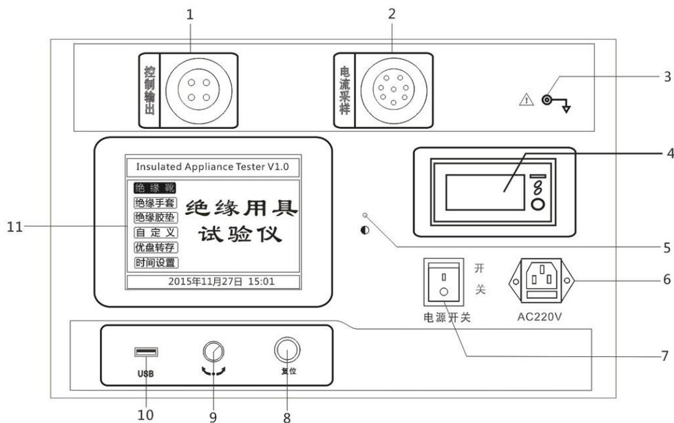
图 1.1 绝缘靴（手套）操作箱面板结构图
