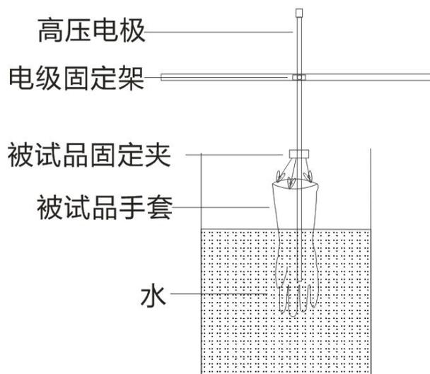
图 4.3 绝缘手套试验示意图
