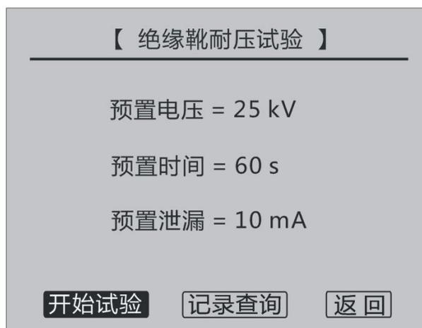
图 3.2 绝缘靴试验
