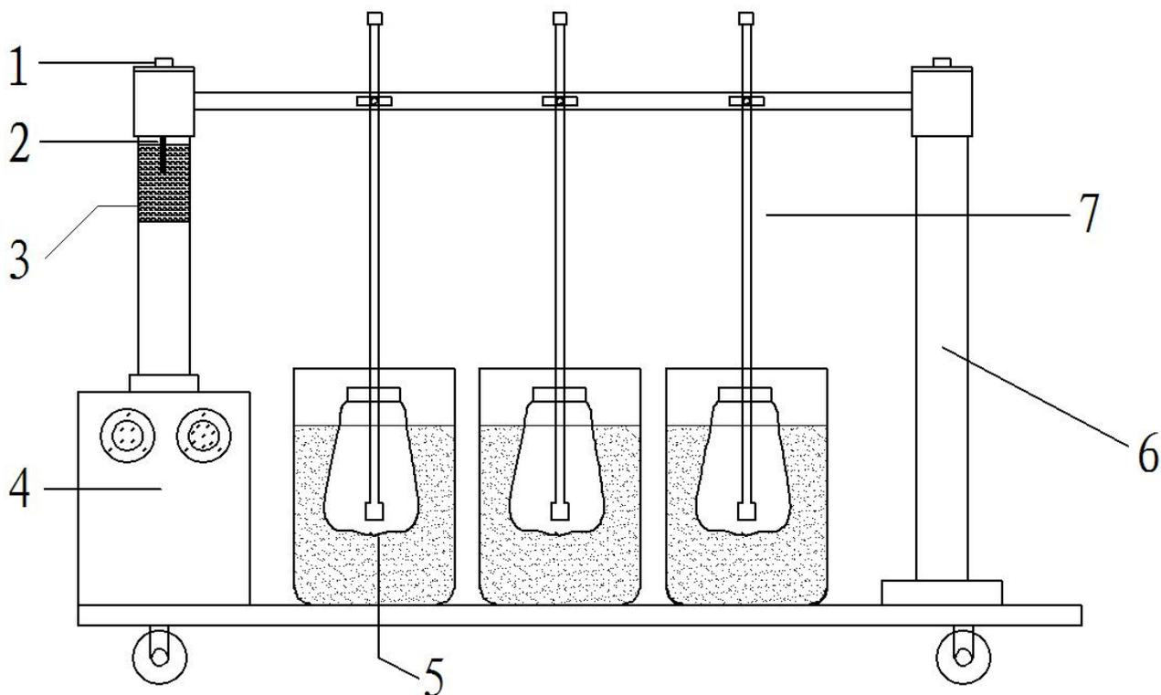
图 1.2 绝缘靴（手套）试验车
