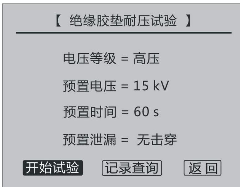
图 3.8 绝缘胶垫界面
