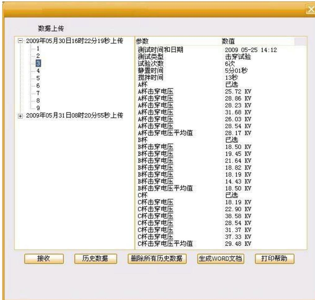
图5.10 数据上传应用程序主界面 1) 在串口线已经连接的状态下，点击接收数据按钮，存储在仪器上的历史数据都将被传输到计算机。传输完成后，程序会提示用户将上传的数据存储为 WORD 文档，用户可以打开 WORD 文档进行编辑和打印。
