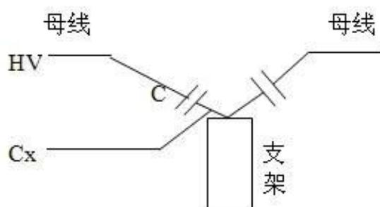
图 10 断路器断口电容试验接线
