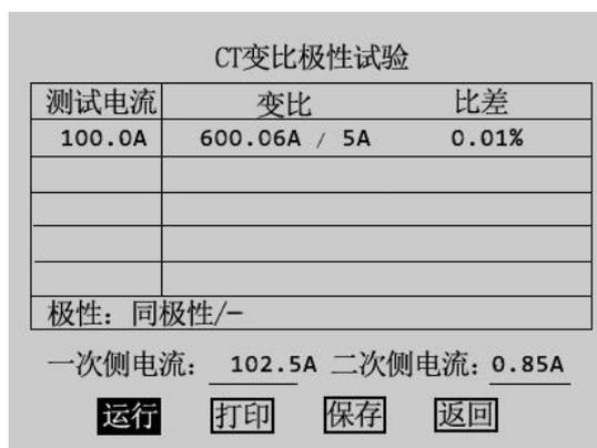
图 7.4 CT 变比极性试验结果界面
