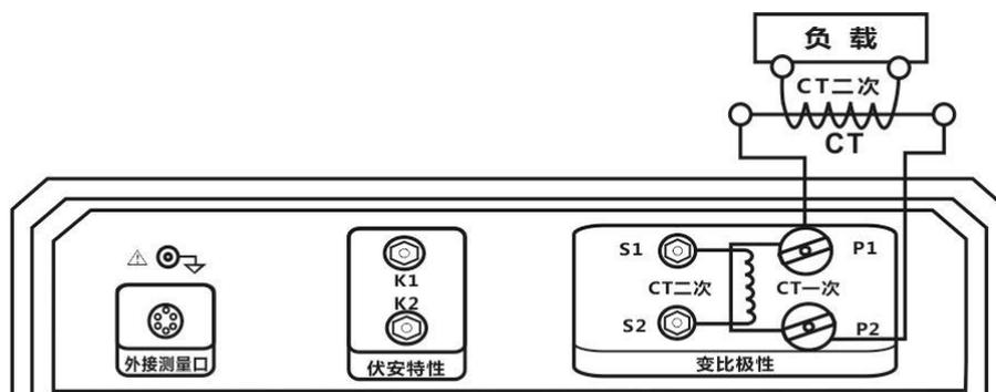
图 3.28 CT 一次通流试验接线
