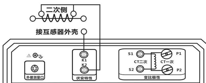
图 3.24 CT 交流耐压试验接线
