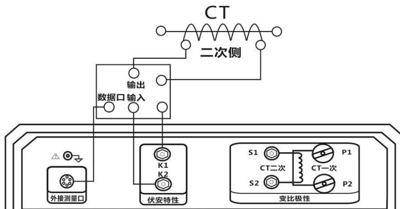
图 3.6 CT 伏安特性试验外接升压器试验
