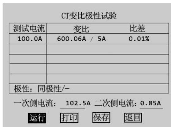
图 3.21 CT 变比极性试验结果界面
