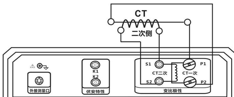
图 3.19 CT 变比极性试验接线
