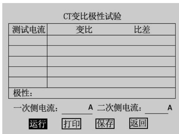
图 3.20 CT 变比极性试验测试界面
