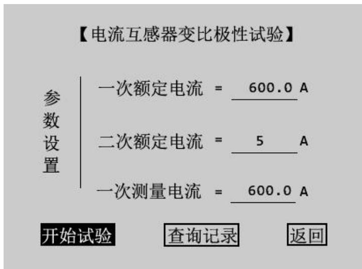
图 3.18 CT 变比极性试验设置界面
