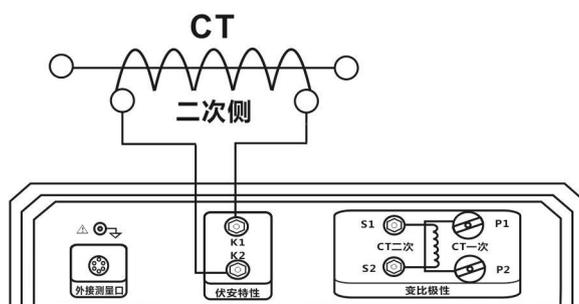
图 3.3 CT 伏安特性单机试验接线图
